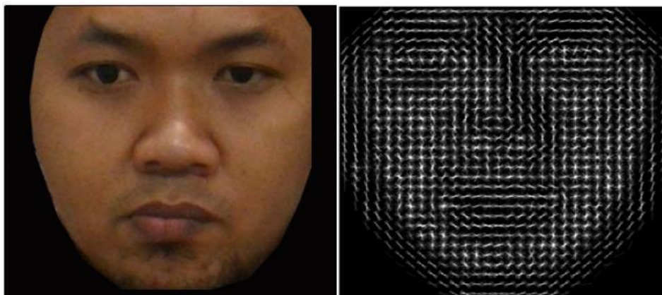
Gambar 3. metode HOG untuk mendeteksi wajah
